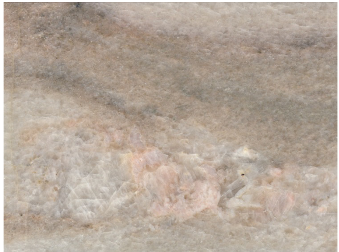
Abb. 3. Mustertafel des Schneebergmarmors mit grobkristallinen Segregationen (Ausschnitt ca. 11 × 9 cm).
