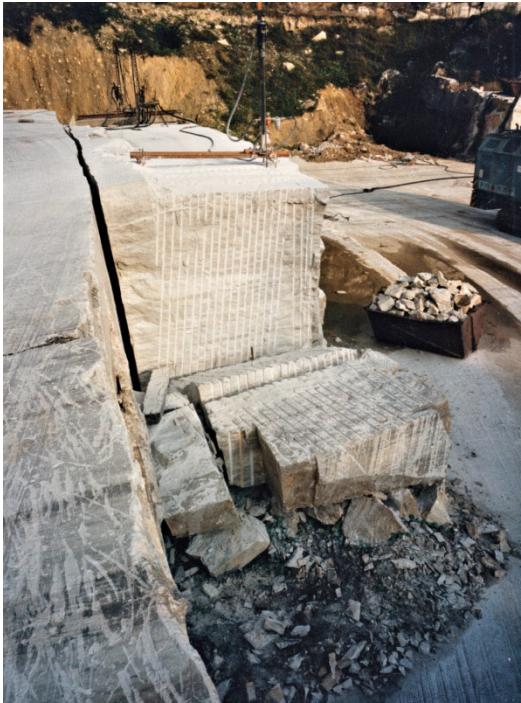
Abb. 19. Zerteilte Rohblöcke nach Wandfällung.
