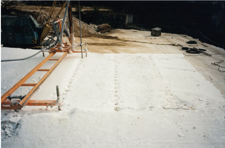
Abb. 18. Senkrechtes Abbohren zur Rohblockgewinnung.
