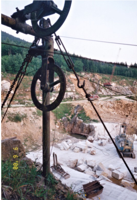
Abb. 14. Umlenkrolle der Helikoidalsäge.
